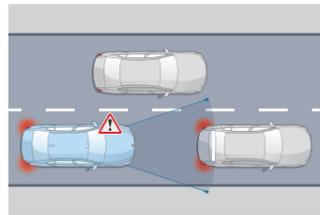
**Détection de collision avant avec freinage**
