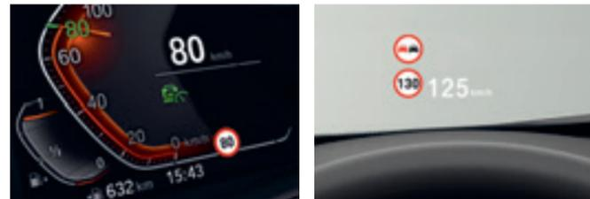
**Speed Limit Info** vous évite d'être pris en défaut dans votre conduite. Pour plus d'efficacité, l'affichage des limitations de vitesse et des interdictions de dépassement se fait à la fois sur le tableau de bord et dans l'affichage Tête Haute HUD en couleur (équipement en option).
