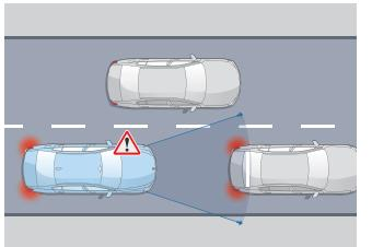
Détection de collision avant
