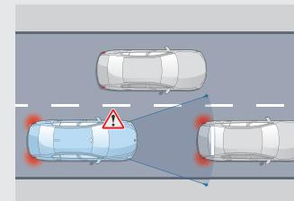
**Détection de collision avant avec freinage**
