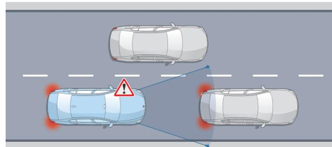
**Détection de collision avant avec freinage**
