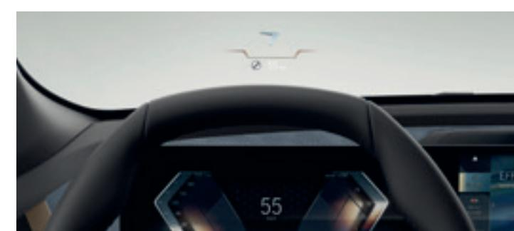
**Speed Limit Info** vous évite d'être pris en défaut dans votre conduite. L'affichage des limitations de vitesse et des interdictions de dépassement se fait à la fois sur le tableau de bord et dans l'affichage Tête Haute HUD en couleur.
