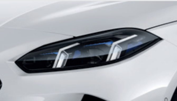
Pack Advanced Full LED : L'équipement comprend une gestion automatique des feux de route. La fonctionnalité anti-éblouissement "BMW Selective Beam" avec projecteurs directionnels répartit de façon variable le faisceau lumineux pour un éclairage optimal de la route dans l'obscurité.
