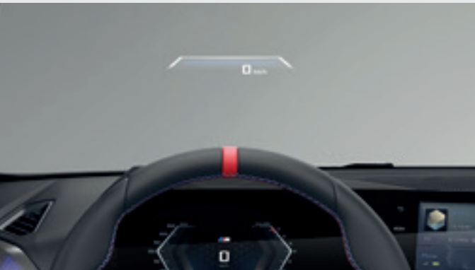
L’Affichage Tête Haute en couleur projette les informations de conduite importantes dans le champ de vision du conducteur pour lui permettre de rester concentré sur la route : vitesse, instructions de navigation, limitation de vitesse...
