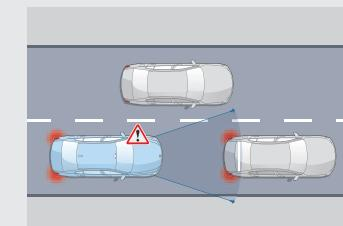
**Détection de collision avant avec freinage**
