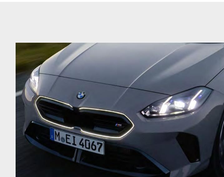
**Pack Advanced Full LED :** L'équipement comprend une gestion automatique des feux de route. La fonctionnalité anti-éblouissement "BMW Selective Beam" avec projecteurs directionnels répartit de façon variable le faisceau lumineux pour un éclairage optimal de la route dans l'obscurité.
