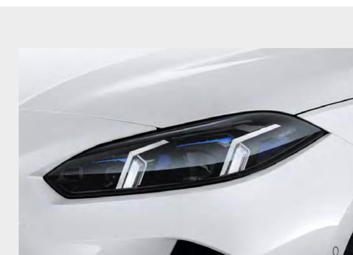
**Pack Advanced Full LED** : L'équipement comprend une gestion automatique des feux de route. La fonctionnalité anti-éblouissement "BMW Selective Beam" avec projecteurs directionnels répartit de façon variable le faisceau lumineux pour un éclairage optimal de la route dans l'obscurité.
