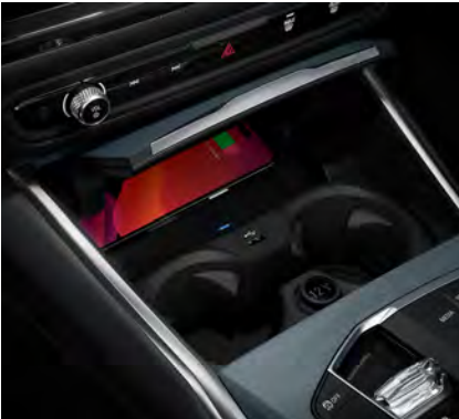
Recharge de smartphone sans fil par induction
