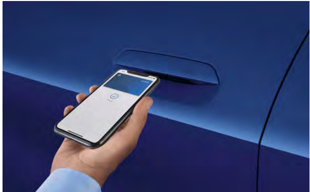
Accès confort. Ouverture/démarrage par pression d'un bouton. Ouverture/fermeture du hayon par mouvement du pied sous le bouclier arrière. Accès et démarrage par clé numérique sur smartphone (Digital key).
