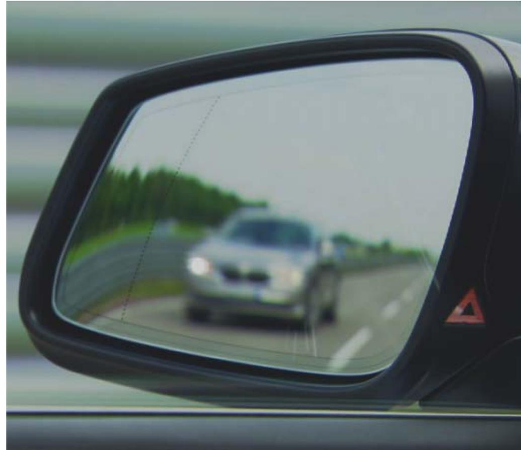
lampeggiante. Inoltre, subentra un secondo avvertimento sotto forma di vibrazioni al volante che corrisponde al segnale di Lane Departure Warning.
