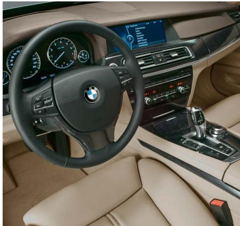
alluminio. BMW è la prima casa automobilistica del mondo ad avere realizzato una serie di comandi in un materiale ceramico altamente tecnologico. Come optional, l'iDrive Controller, il selettore di marcia elettronico e la manopola di regolazione del climatizzatore automatico e dell'impianto audio sono fornibili, in alternativa al metallo galvanizzato di serie, anche in materiale ceramico.
