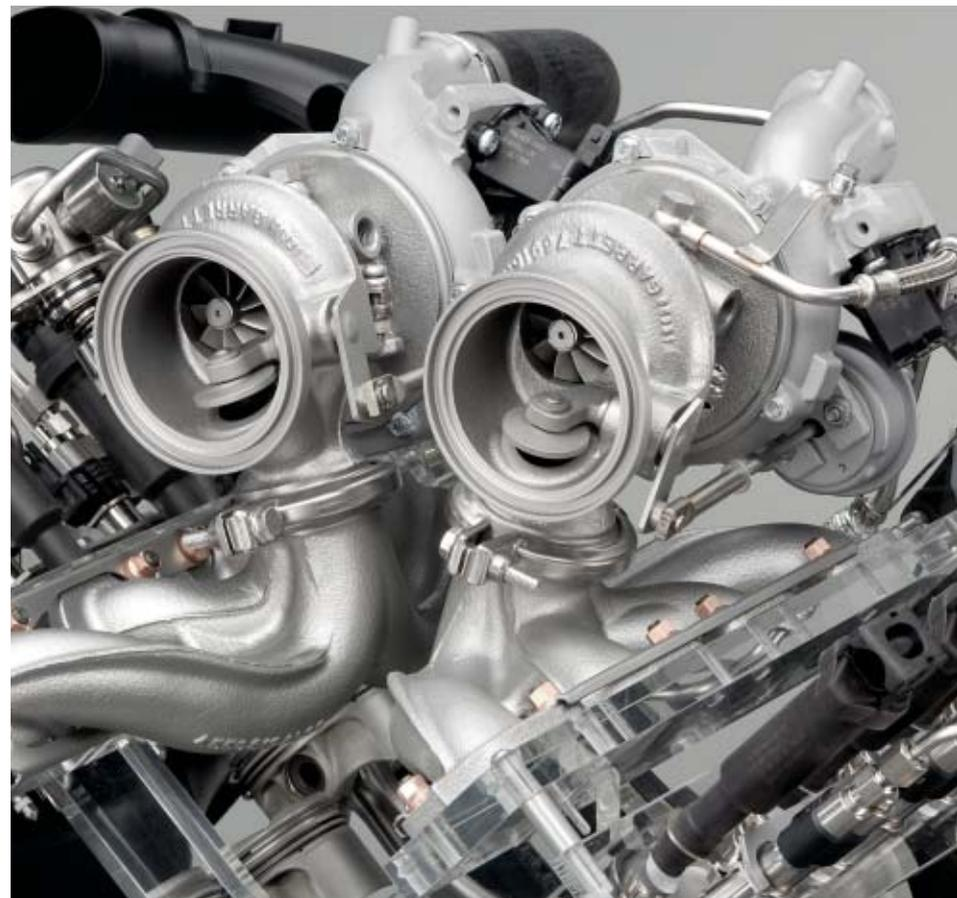
propulsore con basamento in alluminio è molto più leggero. Ma non solo il peso, bensì anche il consumo di carburante del nuovo propulsore V8 si attestano a un livello incredibilmente basso per un motore di questa categoria di potenza. Un fattore importante per raggiungere dei valori di consumo vantaggiosi è il tipico comando continuo degli alberi a camme che caratterizza i motori BMW, il Doppio VANOS. Il sistema consente al motore di erogare una coppia elevata già a regimi bassi.
