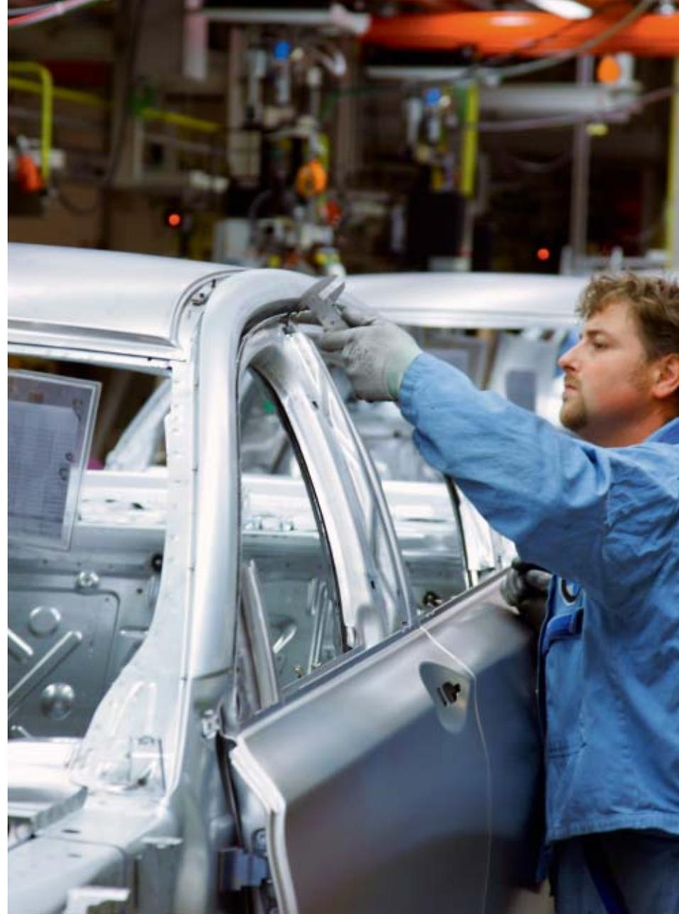
caratteristica nelle portiere della nuova berlina. In aggiunta al tetto, anche il cofano motore, le fiancate anteriori e i duomi molla anteriori della scocca sono stati realizzati in leghe leggere.
