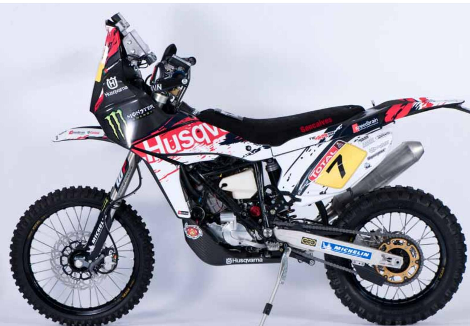
Wassergekühlter Einzylinder-Viertaktmotor, zwei obenliegende Nockenwellen, vier Ventile, Trockensumpfschmierung mit Ölkühler, elektronische Saugrohreinspritzung/digitale Motorsteuerung
