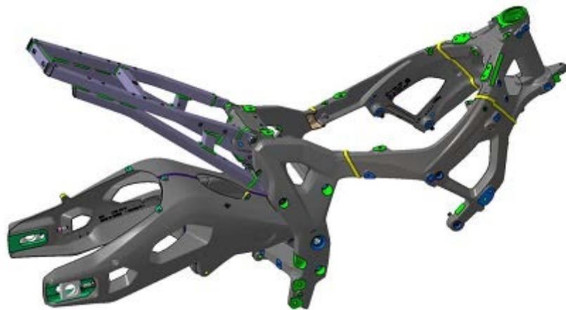
**Nuevo marco «Flex Frame», mucho más ligero, que integra el motor en el bastidor con una función aumentada de reparto de la carga.**
