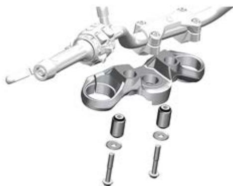
de unos manguitos de goma prensados que permiten un desacoplamiento más efectivo, sin incidir en la precisión del manubrio ni de dirección.
