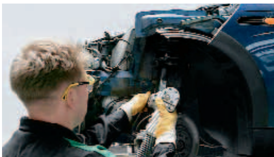
Estrazione dell'olio dagli ammortizzatori: gli esperti di riciclaggio del BMW Group hanno sviluppato insieme a un'azienda partner un dispositivo per l'estrazione rapida e sicura dell'olio.
