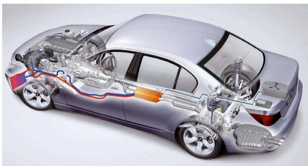
Questo genere di sistema di riciclo termico offre anche l'opportunità di fornire calore ulteriore a diversi sub-sistemi nell'automobile, come la trasmissione o il riscaldamento quando si avvia il motore a freddo, aiutando anche qui a migliorare lo standard complessivo di efficienza.
