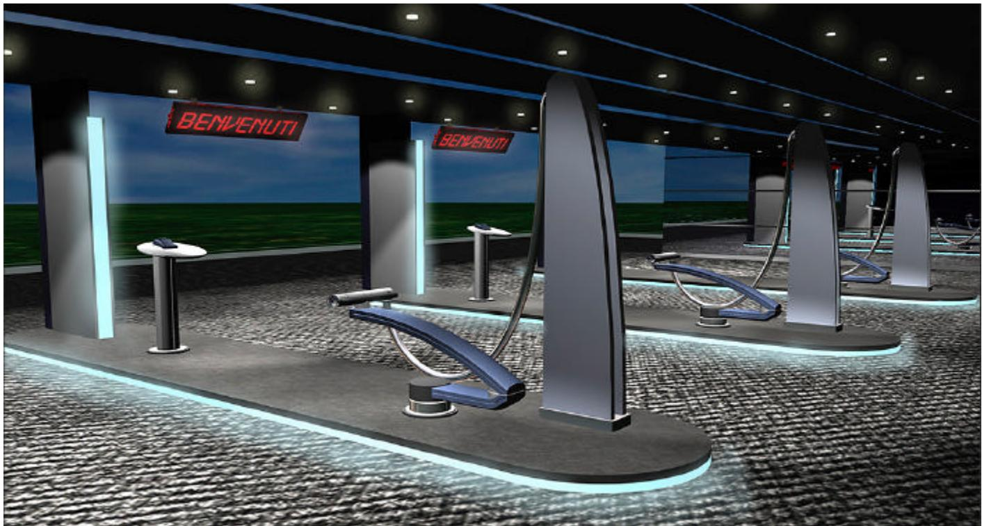
La stazione per l'erogazione di idrogeno proposta da questo progetto assomiglia ai caselli autostradali. Elementi leggeri e schematici sono situati sotto una copertura lineare. Un "unghia" sostiene il tubo che conduce l'idrogeno liquido fino alla "pistola" di erogazione. Lo schermo informativo complementare è fissato alla copertura. Il meccanismo che regola il funzionamento del braccio (direttamente mutuato dalle macchine radiografiche per dentisti) appare particolarmente innovativo.
