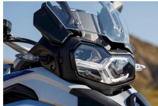
Esso non solo illumina la strada con un fascio che non ha rivali in termini di brillantezza e luminosità, ma garantisce anche una migliore visibilità nel traffico. Inoltre conferisce alle due moto un look inequivocabile, grazie all'iconico disegno dei LED in fibra ottica disposti a forma di diapason rovesciato. La struttura del faro è composta da due unità LED, una per il fascio basso e una per il fascio alto, oltre ad altre quattro unità LED per la luce diurna e la luce laterale.
