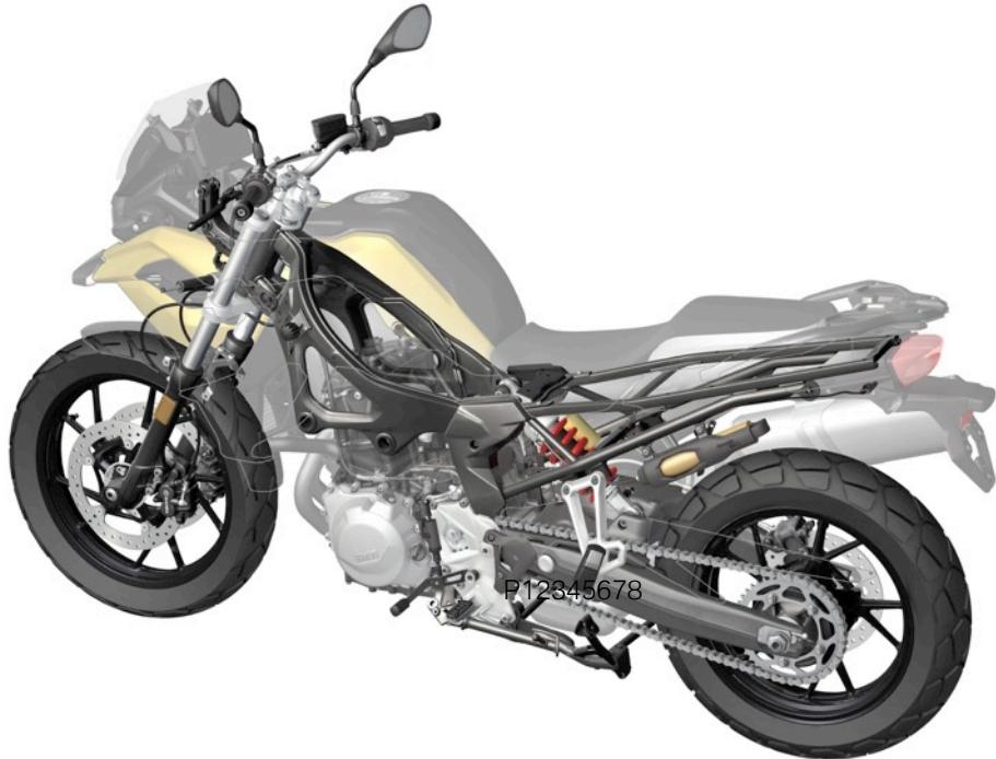
**Sospensioni di nuova progettazione con telaio a ponte in acciaio imbutito per una maggiore rigidità, robustezza e precisione di guida.**
