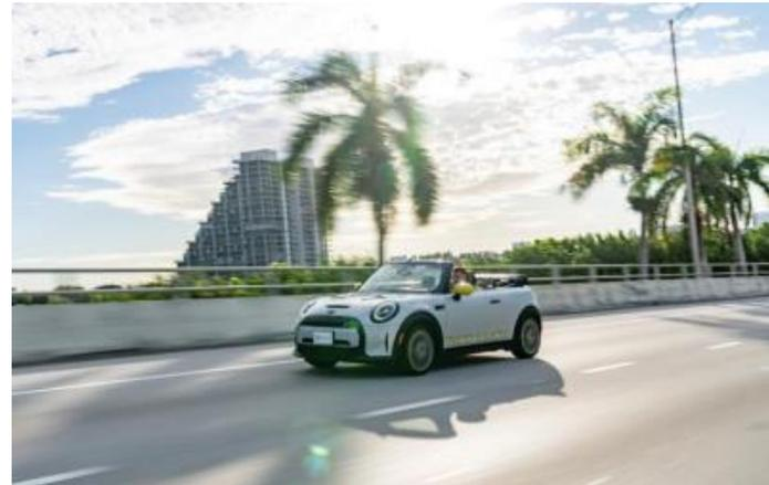
Questo esemplare è basato sulla carrozzeria della MINI Cooper S Cabrio. La MINI Cabrio elettrificata ha le stesse dimensioni di 3.863 mm di lunghezza con un passo di 2.495 mm, una larghezza di 1.727 mm e un'altezza di 1.415 mm. Anche il volume di carico del bagagliaio rimane invariato a 160 litri.
