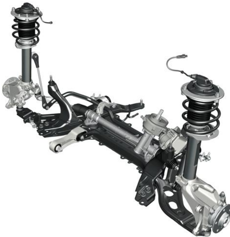
シングル・ジョイント・ スプリング・ストラット 式フロント・アクス ル。
