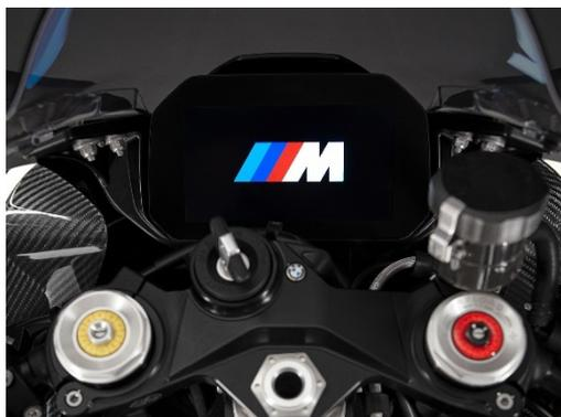
新型 MRR のメーター・パネルは RR と同じベーシック・デザインで、M スタート・アニメーションが備わります。オプション装備品の一環として、アクティベーション・コード (M コンペティション・パッケージの一部) を使用すると、メーター・パネルの OBD インターフェースを通じて、M GPS ラップトリガーと M GPS データ・ロガー (BMW Motorrad 純正アクセサリ) を使用するための網羅的なデータ材料が得られます。
