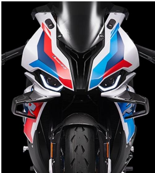
ことに加え、MRRの技術仕様には、もう一つの目標がありました。それは、特に加速時のホイールと路面との接触を可能な限り最高にすることでした。これを踏まえ、サーキットとBMWグループの風洞での徹底的なテストを通じて、フロント・トリムのクリア・コート・カーボン製Mウイングレットが開発されました。このMウイングレットは、速度に応じて空力的なダウンフォースを生成し、ホイール・ロードを増大させます。フロント・ホイールのホイール・ロードの増大によって、ウィリーの傾きが相殺され、トラクション・コントロールの制御が減り、さらに多くの駆動力が加速に変換され、ラップ・タイムの短縮が可能になります。
