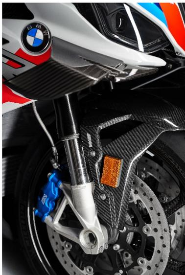
M RR の M カーボン・ホイールではカーボンが理想的に使用されており、オートクレーブと呼ばれる高圧炉での非常に複雑な工程を経て処理されています。これによる利点は明白で、ここでは軽量がすなわち回転質量の低減を意味することから、加速および減速性能の向上に加え、ハンドリングも最適化されています。要するに、M カーボン・ホイールによって、さらなる俊敏性とドライビング・ダイナミクスが M RR に備わっています。
