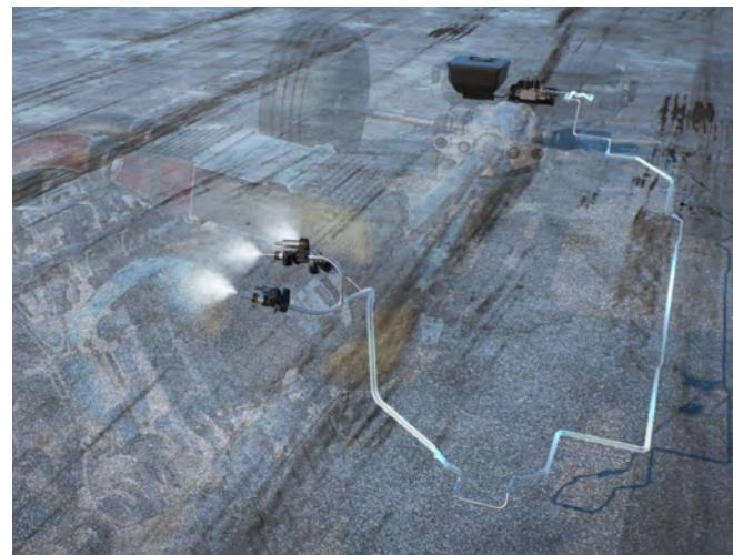
Al colocar la inyección de agua, los ingenieros de BMW M GmbH optaron por un diseño con tres válvulas de inyección en la cámara de distribución, cada uno suministrando a dos cilindros de los seis cilindros del motor en línea. Esta solución asegura una distribución ideal que también permite que el sistema sea diseñado de manera compacta.
