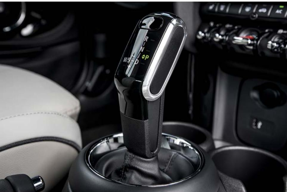
двойным сцеплением. Новый тип трансмиссии характеризуется очень быстрым переключением передач, что позволяет совершать чрезвычайно спортивный маневр ускорения без прерывания крутящего момента. Работа механизма обеспечивается за счет нового электронного рычага переключения передач.
