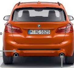
Todos los motores de cuatro cilindros tienen dos tubos de escape (diámetro: 90 mm).
