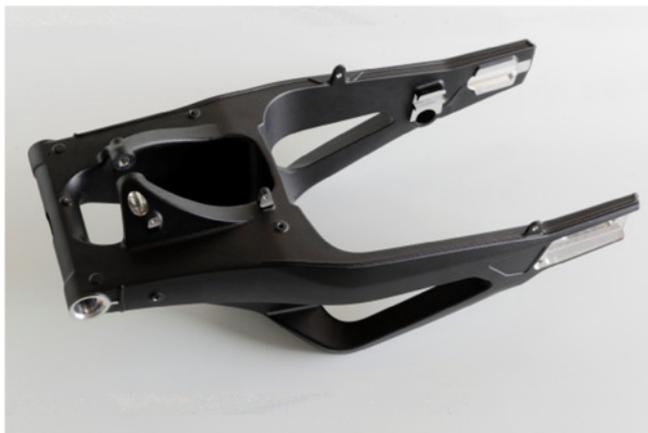
El objetivo de este nuevo diseño general era colocar el amortiguador central lo más lejos posible del motor, eliminando así el calor no deseado como resultado de disipar el calor del motor. Esto se traduce en una respuesta de temperatura más estable, lo que garantiza unas fuerzas de amortiguación
