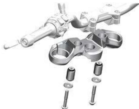
de unos manguitos de goma prensados que permiten un desacoplamiento más efectivo, sin incidir en la precisión del manubrio ni de dirección.
