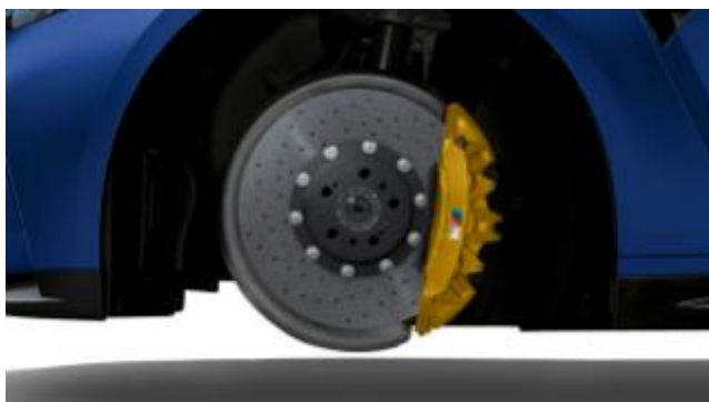
Disco de freno ventilado, izquierda perforado
