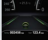
Lenk- und Spurführungsassistent bis 210 km/h.
