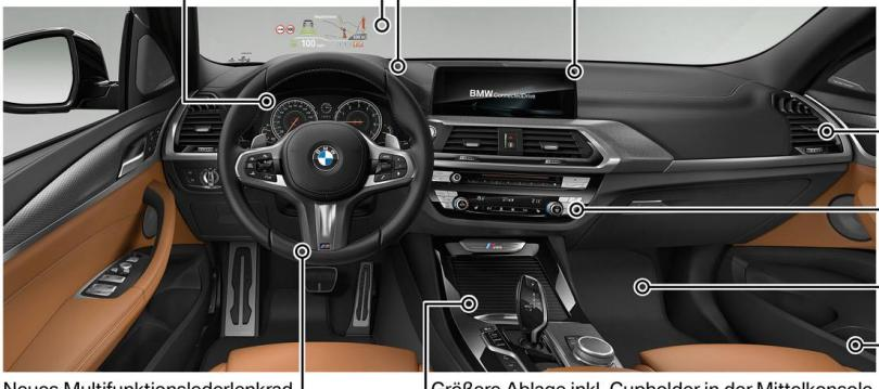
12,3“ Instrumentenkombi (optional). | Vollfarbiges Head-Up-Display (optional). | Sensatec i-Tafel (optional). | 10,2“ Touchdisplay mit Gestensteuerung (optional).
