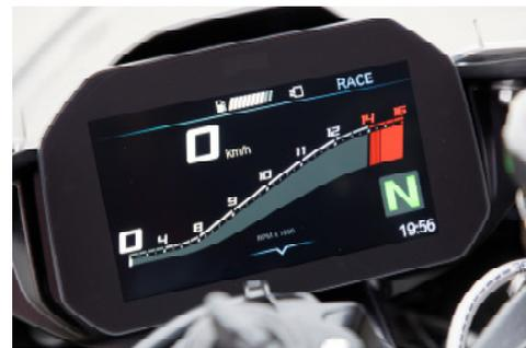
Neben einem erweiterten Funktionsumfang und Informationsangebot legten die BMW Motorrad Entwickler insbesondere Wert auf eine bestmögliche Ablesbarkeit des 6,5 Zoll großen TFT-Displays. Für eine optimale Darstellung – selbst unter schwierigen Lichtverhältnissen – wurde das Display deshalb groß und damit gut ablesbar gestaltet. Es ist mit dem Multi Controller an der linken Lenkerarmatur verknüpft und lässt sich hierüber schnell, sicher und komfortabel bedienen.
