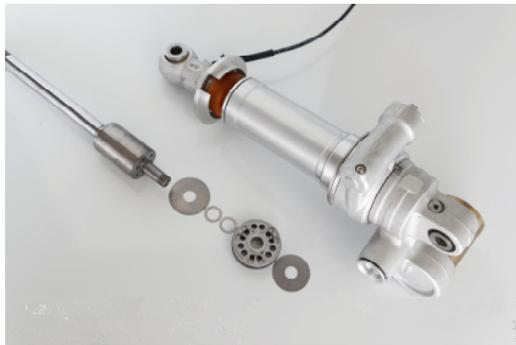
Die DDC-Dämpferventile des Vorgängermodells waren in Serie geschaltet. Der Volumenstrom floss durch den konventionellen und elektrisch einstellbaren Dämpfungsanteil. Die konventionelle Dämpfung war die geringste Dämpfung, die dargestellt werden konnte. Mit dem elektrischen DDC-Ventil wurde die Dämpfung erhöht. Dies führte aber zu dem bekannten Nachteil, dass der Kompromiss zwischen Komfort- und hoher Dämpfung tendenziell zu einer Unterdämpfung und zum Pumpen des Fahrwerks führen konnte.
