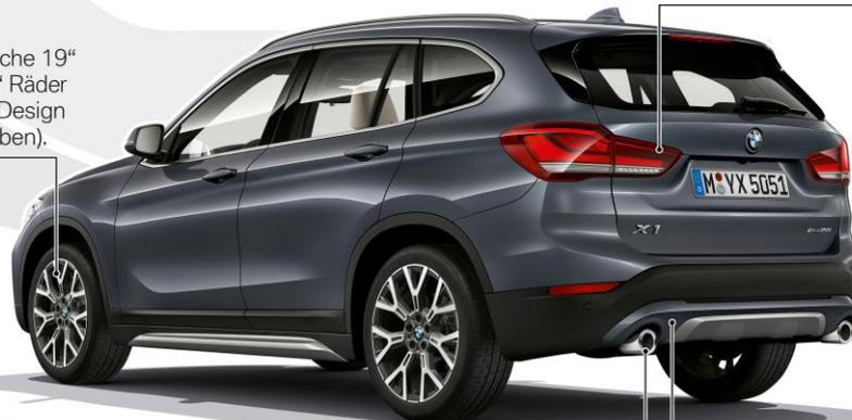
Durchmesser der Endrohre von 70 auf 90 mm vergrößert.
