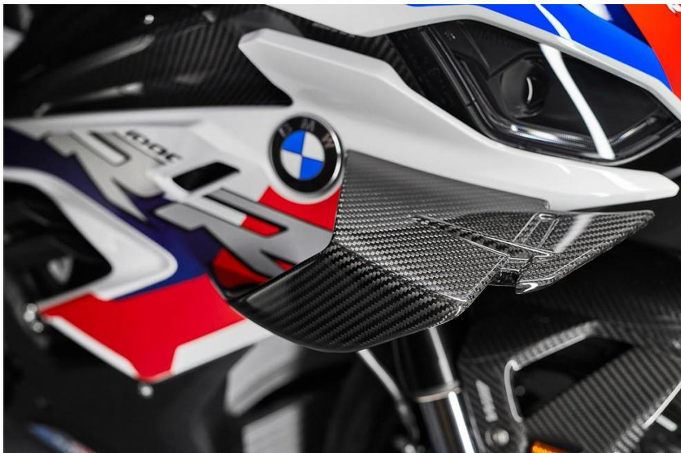
Die Entwicklungsarbeiten für die M Winglets fanden sowohl bei Testfahrten auf der Rennstrecke als auch im Windkanal der BMW Group statt. Dabei wurden an der Front- und Heckpartie der neuen M RR die nachstehend aufgeführten Abtriebswerte ermittelt:
