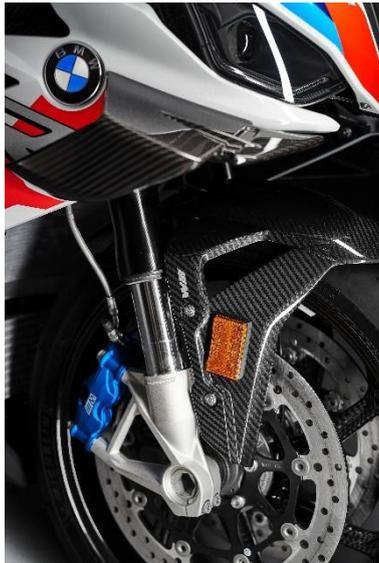
Ein idealer Anwendungsbereich für das in einem sehr aufwendigen Verfahren mit Hochdrucköfen – sogenannten Autoklaven – verarbeitete Material sind die M Carbon Räder der M RR, denn die Vorteile liegen auf der Hand. Weniger Gewicht bedeutet hier geringere rotatorische Massen und damit neben einem verbessertem Beschleunigungs- und Bremsverhalten auch ein optimiertes Handling. Kurzum: Die M Carbon Räder machen die M RR noch agiler und fahrdynamischer.
