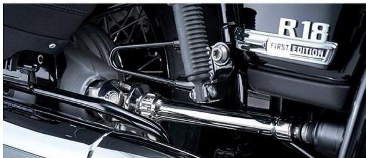
laufen offen. Für den Längenausgleich kommt getriebeseitig ein sogenanntes Tripoidgelenk zum Einsatz.
