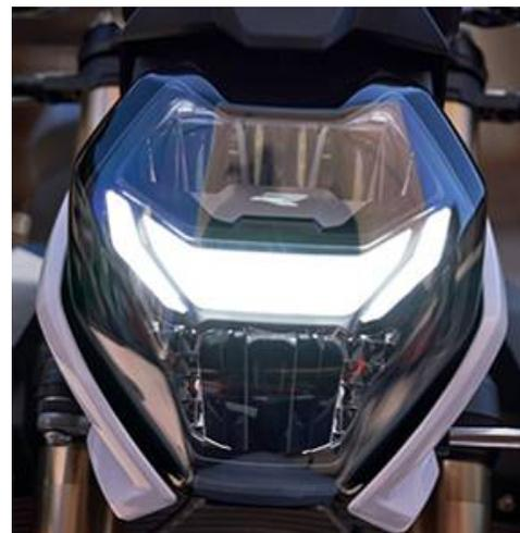
Das Adaptive Kurvenlicht funktioniert über die schräglagenabhängige Zuschaltung von zusätzlichen und mit eigenen Reflektoren ausgestatteten LED-Elementen im Hauptscheinwerfer. Es schaltet sich ab einer Schräglage von mehr als 7° und einer Geschwindig-
