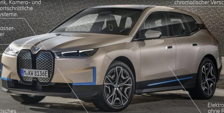
BMW Niere als Intelligenzfläche mit integrierter Sensorik, Kamera- und Radartechnik für fortschrittliche Fahrerassistenzsysteme.
