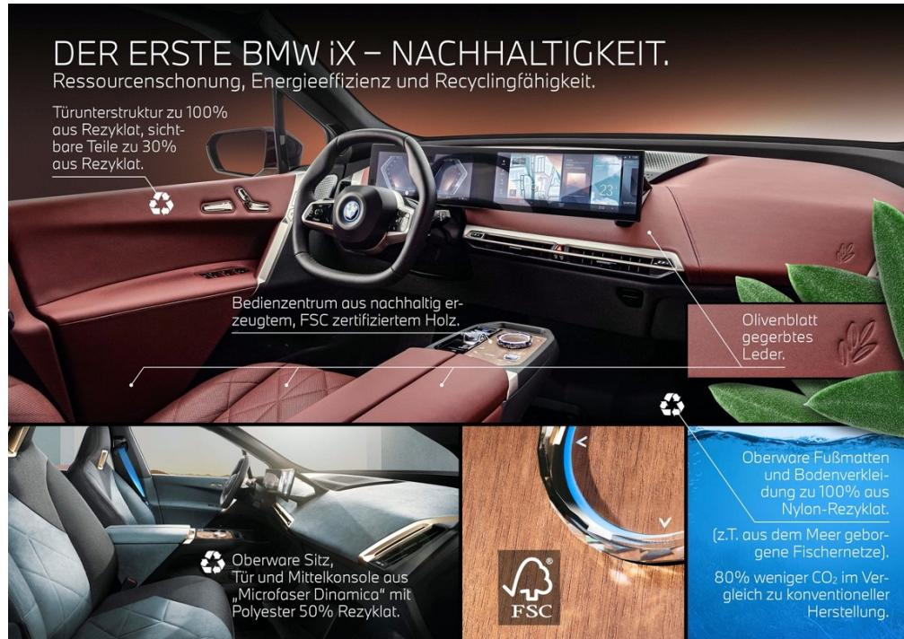
Türunterstruktur zu 100% aus Rezyklat, sichtbare Teile zu 30% aus Rezyklat.
