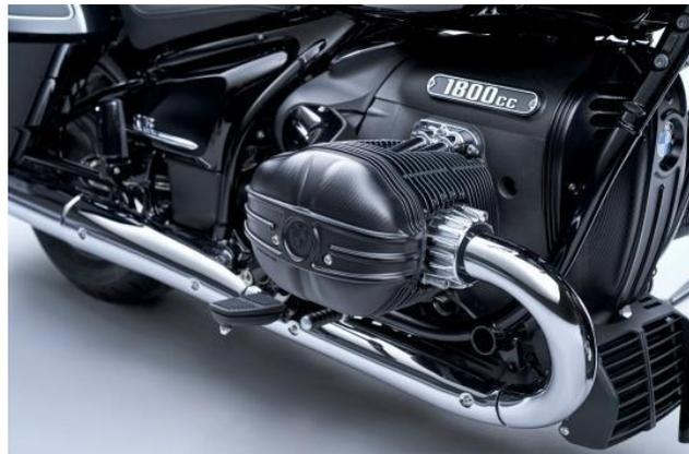
sondern auch in technischer Hinsicht knüpft der neue „Big Boxer“ an die traditionellen Boxermotoren an, die seit Beginn der BMW Motorrad Fertigung im Jahre 1923 rund 70 Jahre lang bis zum Erscheinen des luft-/ölgekühlten Nachfolgers synonym für die Motorräder aus München beziehungsweise Berlin-Spandau standen: klar gezeichnete und im Sinne bester Zuverlässigkeit und Wartungsfreundlichkeit konstruierte Motoren, mit logisch angeordneter, aber gleichwohl leistungsfähiger Technik.
