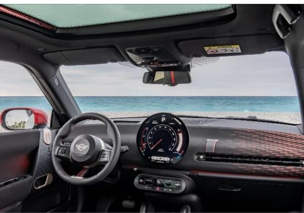
Das zentrale, hochauflösende OLED-Display mit 240 mm Durchmesser bündelt fahrzeugbezogene Daten und informiert über Navigations-, Medien-, Telefon- sowie Klimaeinstellungen. Mit den MINI Experience Modes bietet es neue Möglichkeiten zur Individualisierung. Dazu gehört auch der von John Cooper Works inspirierte GO-KART Mode, der Display sowie Innenraumbeleuchtung Anthrazit-
